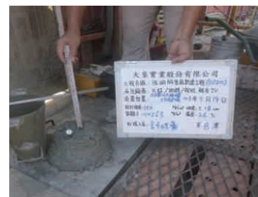
圖說：樓板灌漿前的施工工法展示及氯離子測試及水泥砂漿坍度測試等
