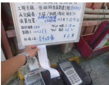
圖說：樓板灌漿前的施工工法展示及氯離子測試及水泥砂漿坍度測試等
